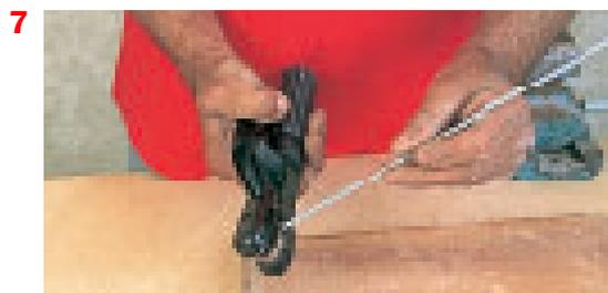
**1. Allumer le poste à souder en veillant, au besoin, à choisir la bonne tension, 220 V en général.**
