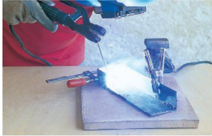
8. Pour amorcer l'arc, frotter la pointe de l'électrode sur la pièce pour créer des étincelles.
