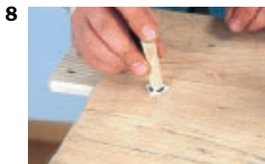
8. Enfiler dans le trou garni de colle un morceau de barre ronde au diamètre du perçage.
